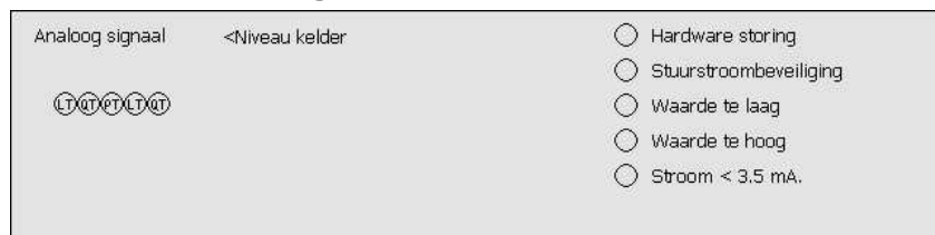
Figuur 12. Touch panel: detail analoge meting, niveau.
